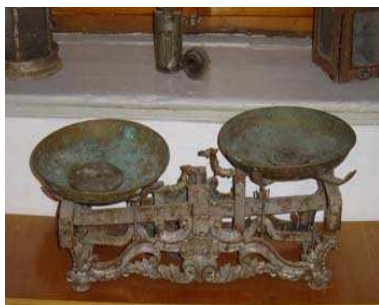
παλάντζα: Ζυγαριά με δύο δίσκους έναν για σταθμά και έναν για το αντικείμενο που ζυγίζεται
