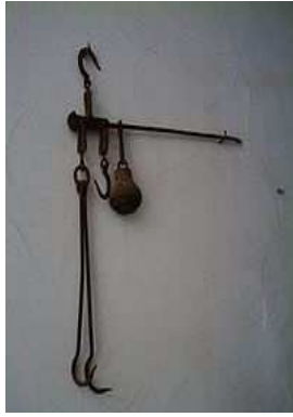
καντάρι: Όργανο μέτρησης βάρους
